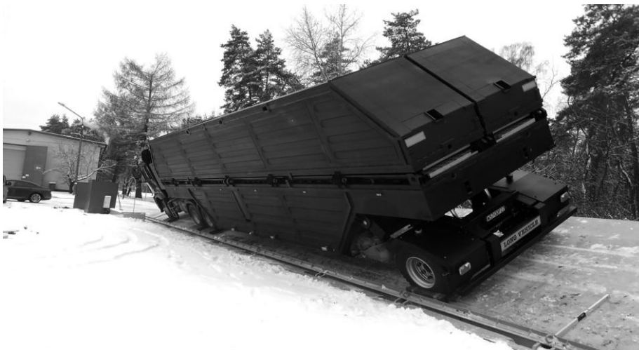
Rys. 6.3.4. Widok pojazdu przy granicznym kącie przechyłu bocznego na lewą stronę.
